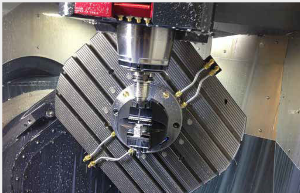
1-fach Nullpunkt Spannsystem VERO-S von SCHUNK Single zero point clamping system VERO-S by SCHUNK
