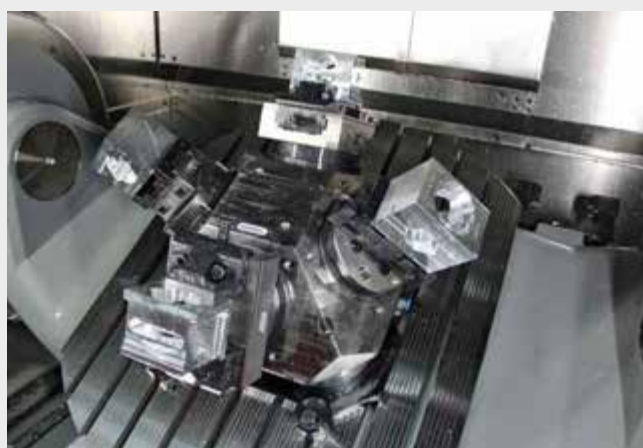
gredoc Pyramide 4-fach Mit 2 C1 65 grip und 2 C2 125 L-160 gredoc pyramid 4-fold With 2 C1 65 grip and 2 C2 125 L-160
