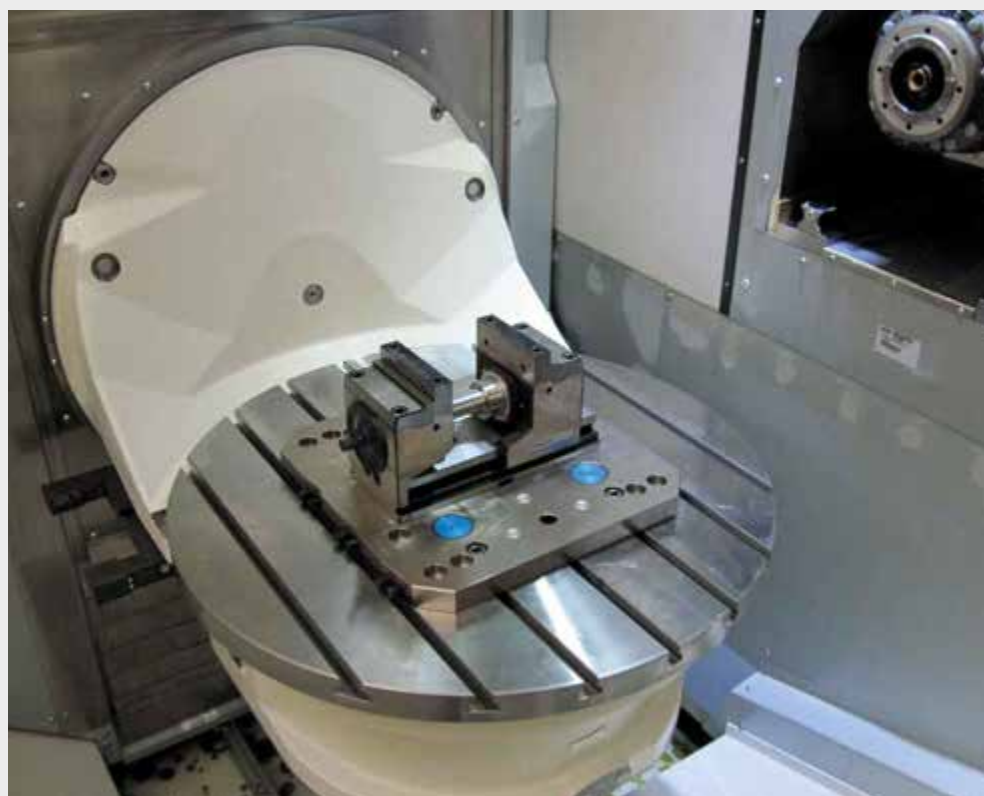
gredoc NRS Platte 6-fach, 400 x 400 mm Mit 1 grepos-5X-S auf Grob 5-Achs Maschine gredoc NRS plate 6-fold, 400 x 400 mm With 1 grepos 5X-S on Grob 5-axis machine
