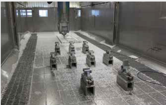
gripos 125-5A-VS-PC 9 gripos 125-5A-VS-PC auf einer grossen Portalfräsmaschine zum Bearbeiten von Flugzeugteilen gripos 125-5A-VS-PC 9 gripos 125-5A-VS-PC on a big portal milling machine for working aeroplane parts
