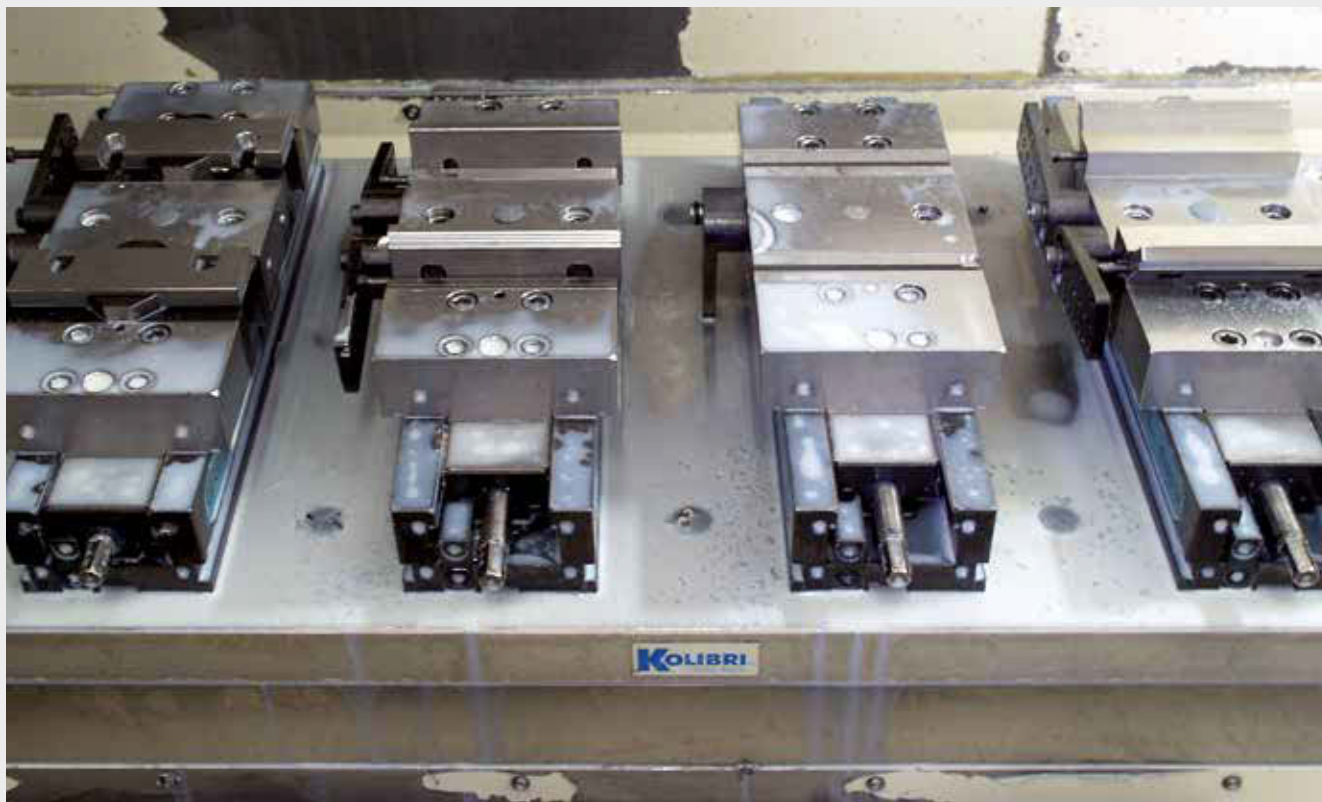
duogrip 100 duogrip 100 mit Backen 125 auf einer Rasterplatte duogrip 100 duogrip 100 with jaws 125 on a raster plate
