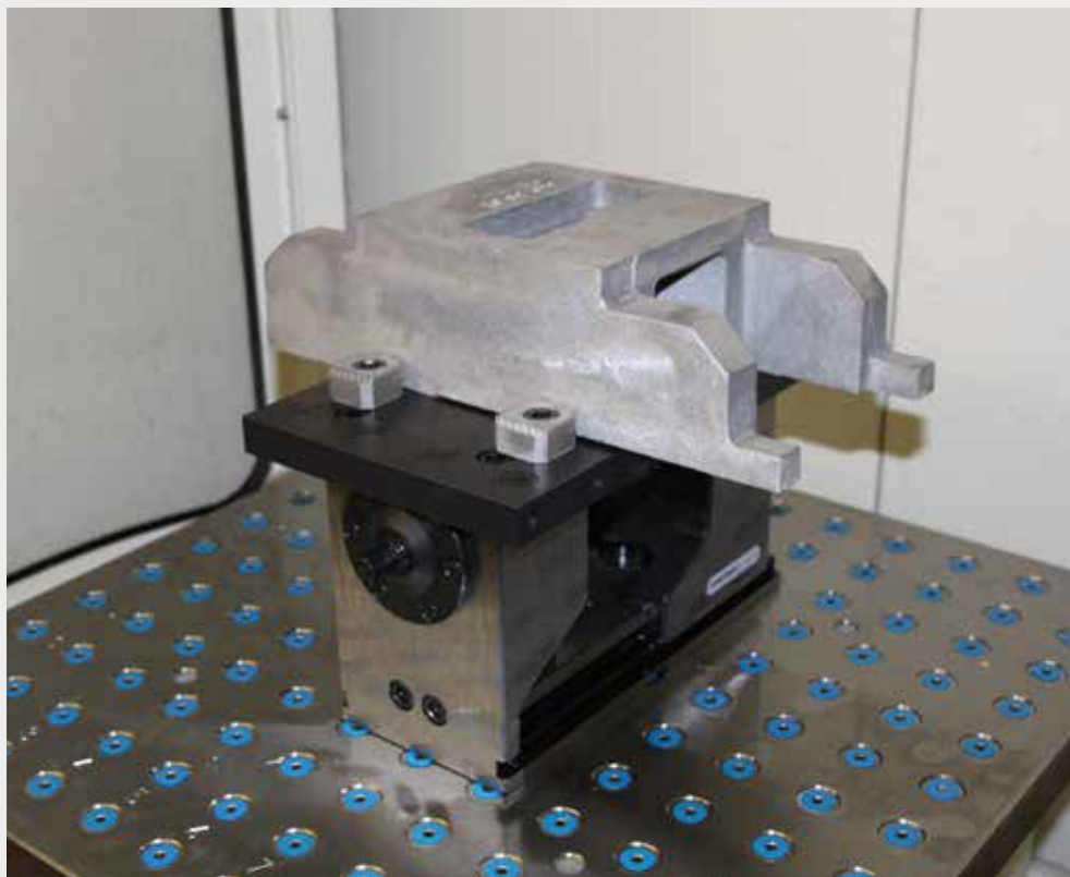
grepos-5X Mit Pendelbackensystem zum Spannen von unförmigen Werkstücken grepos-5X With swivel jaw system to clamp bulky workpieces
