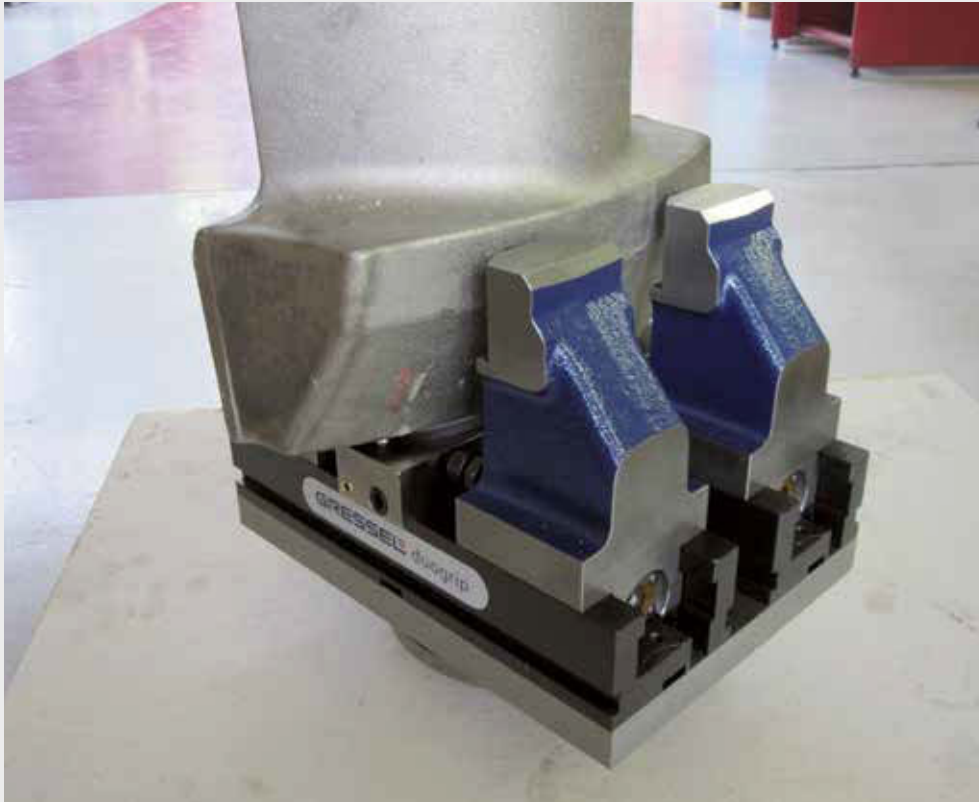
duogrip Spannung einer rohen Turbinenschaufel auf einem Dreh-Fräszentrum mit Spezialbacken grip duogrip Clamping of a blank turbine blade on a turn-milling centre using special grip jaws
