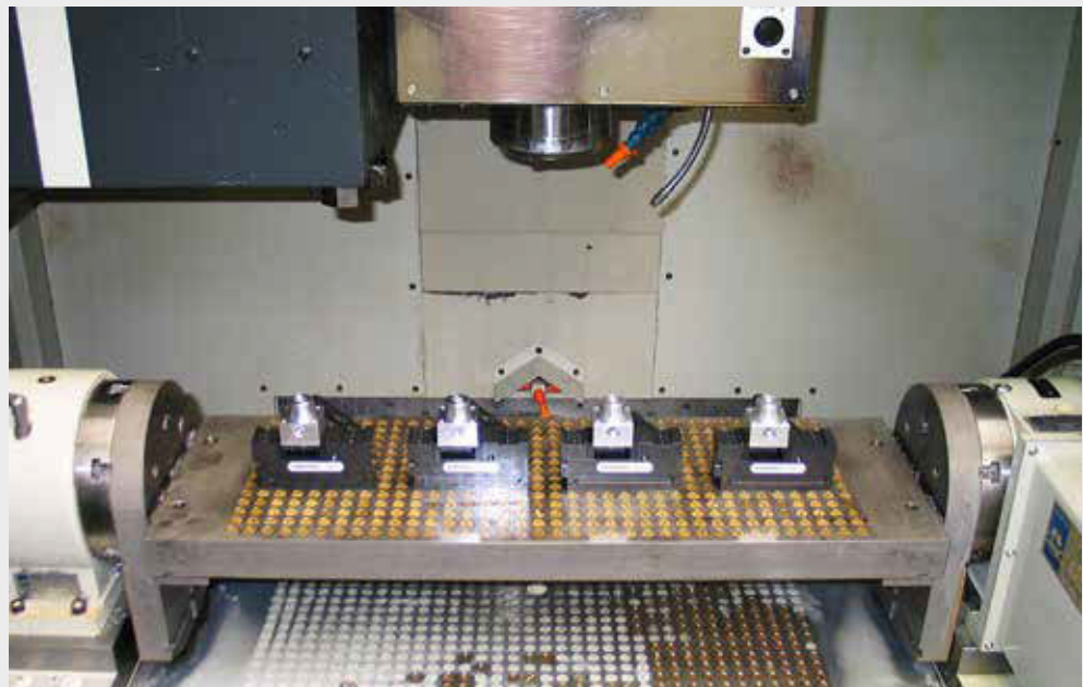
solinos 40 Einfachspanner solinos 40 auf 4. Achse solinos 40 solinos 40 single vice on fourth axis
