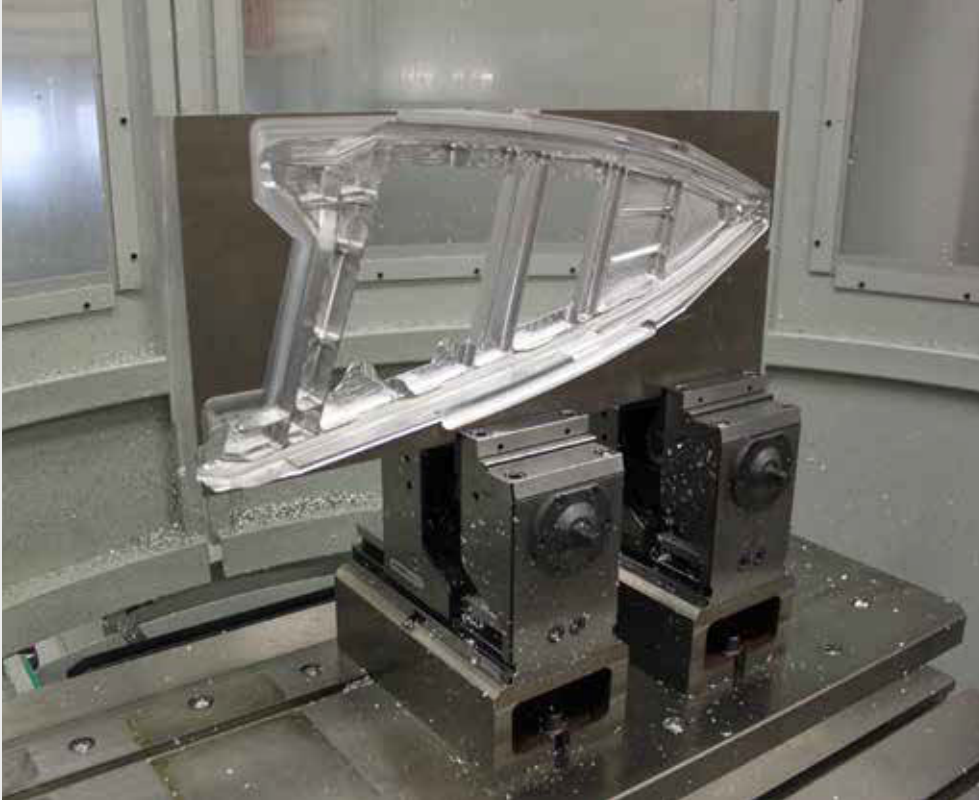
grepos-5X Mit Standard-Aufsatzbacke auf Unterbau zum Spannen von Flugzeugteilen grepos-5X With standard top jaw on substructure for clamp aeroplane workpieces
