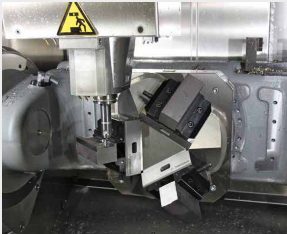
C2 125 L-160 Mit Wendebacken grip auf 3-fach Pyramide C2 125 L-160 With reversible grip jaw on a 3-fold pyramid
