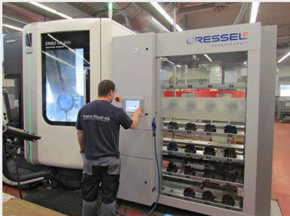
Automatischer Betrieb mit Werkstückspeicher und 56 Spannmitteln Automatic mode with workpiece storage and 56 clamping devices
