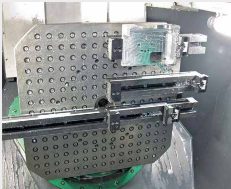
multigrip 90 auf UNISIGN 5-Achsen Maschine 1 Schiene verlängert und 2 Schienen 90-500 multigrip 90 on a UNISIGN 5-axis machine 1 rail extended and 2 rails 90-500
