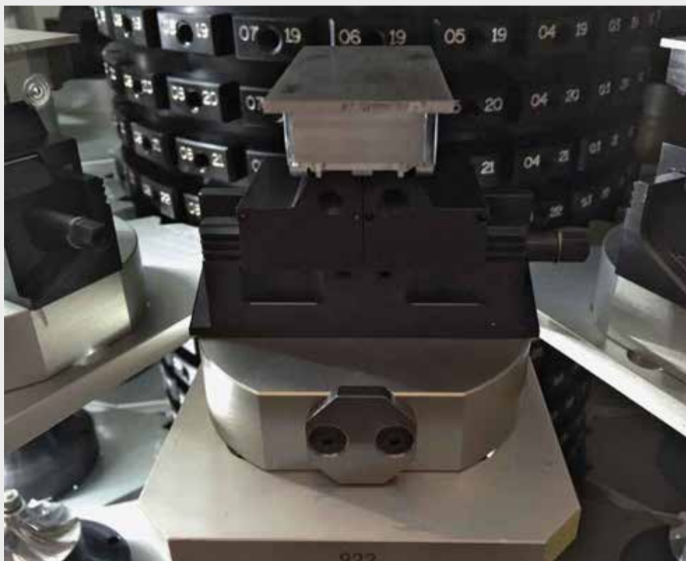
C1 40 Mit Wendebcken grip auf Paletten einer Häberle Automation an einer FANUC Robodrill Maschine C1 40 With reversible grip jaws on palletized with Häberle automation on a FANUC Robodrill machine
