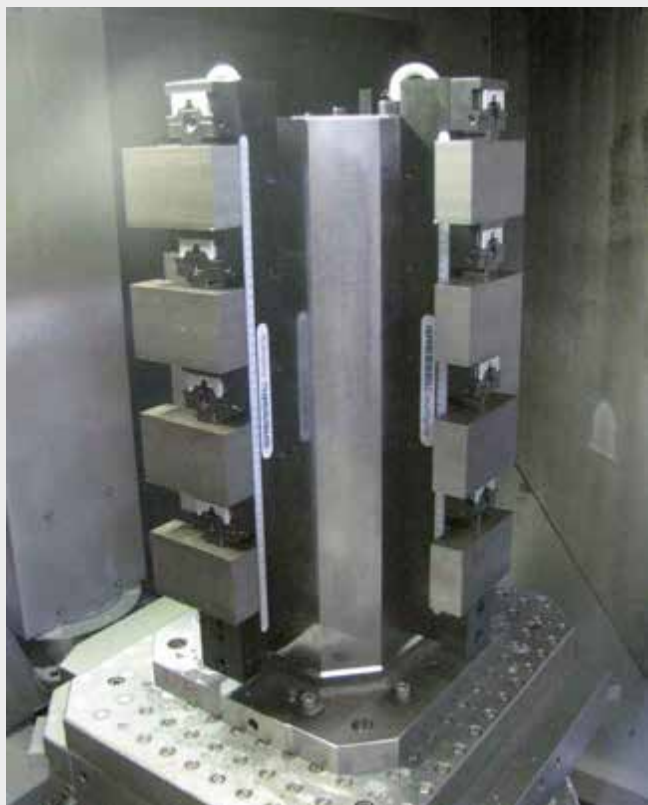
Aufspannturm mit vier multigrip Schienen Spannen von 16 Werkstücken Tombstone with four multigrip clamping rails Clamping of 16 workpieces
