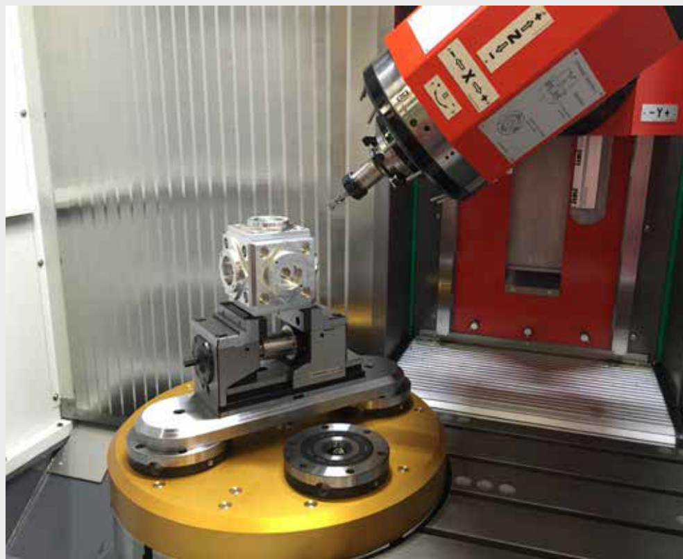
grepos-5X Mit Standard-Aufsatzbacke auf MATEC Maschine mit Zwischenplatte auf SCHUNK VERO-S grepos-5X With standard top jaw on a MATEC machine with between plate SCHUNK VERO-S
