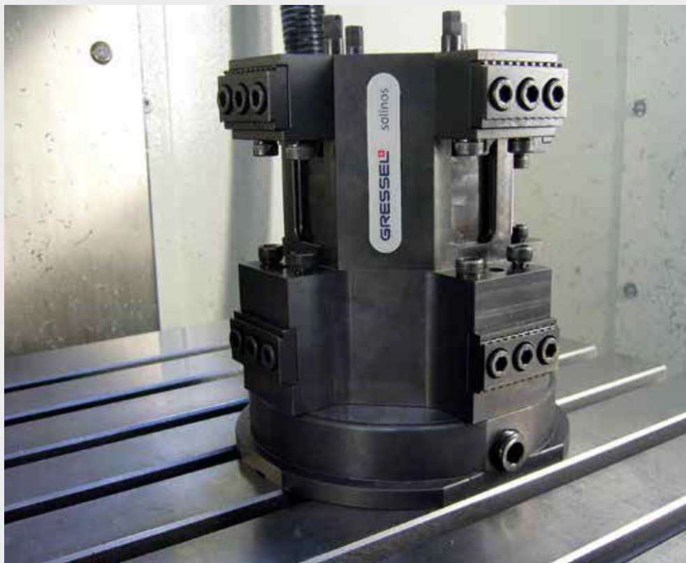
solinos 40-4V-IT Monoblockturm gespannt auf gredoc rund solinos 40-4V-IT Monoblock tombstone clamped on round gredoc
