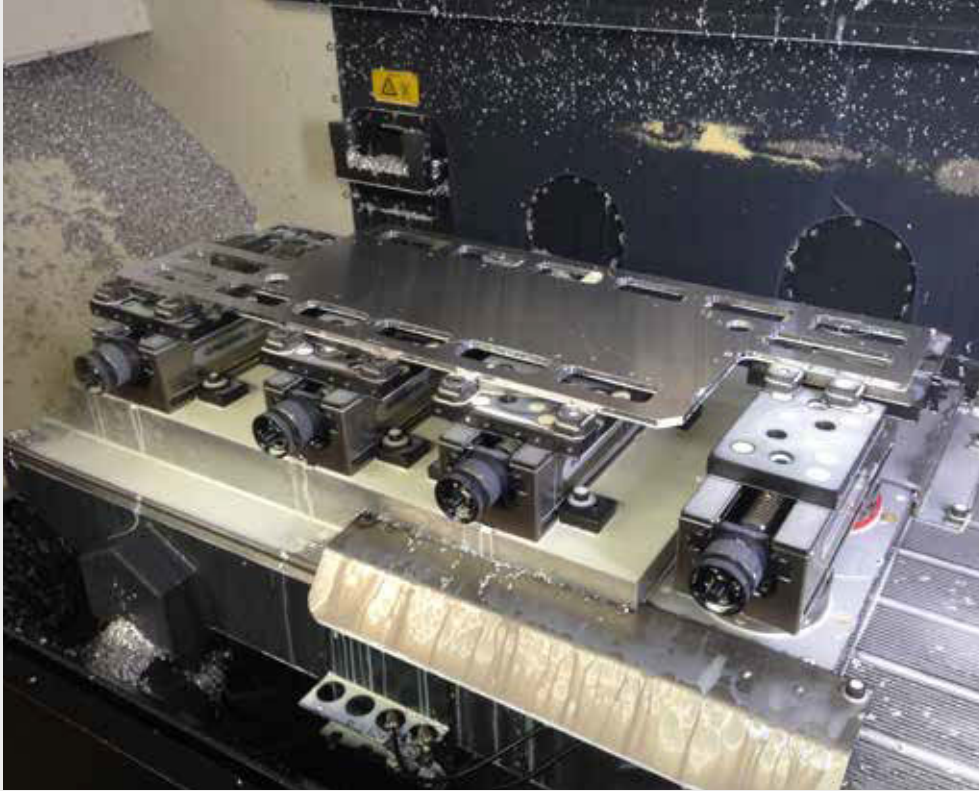
gripos 125-R 4 gripos 125-R mit Pendelbackensystem zum Spannen von unförmigen Werkstücken gripos 125-R 4 gripos 125-R with swivel jaw system to clamp bulky workpieces
