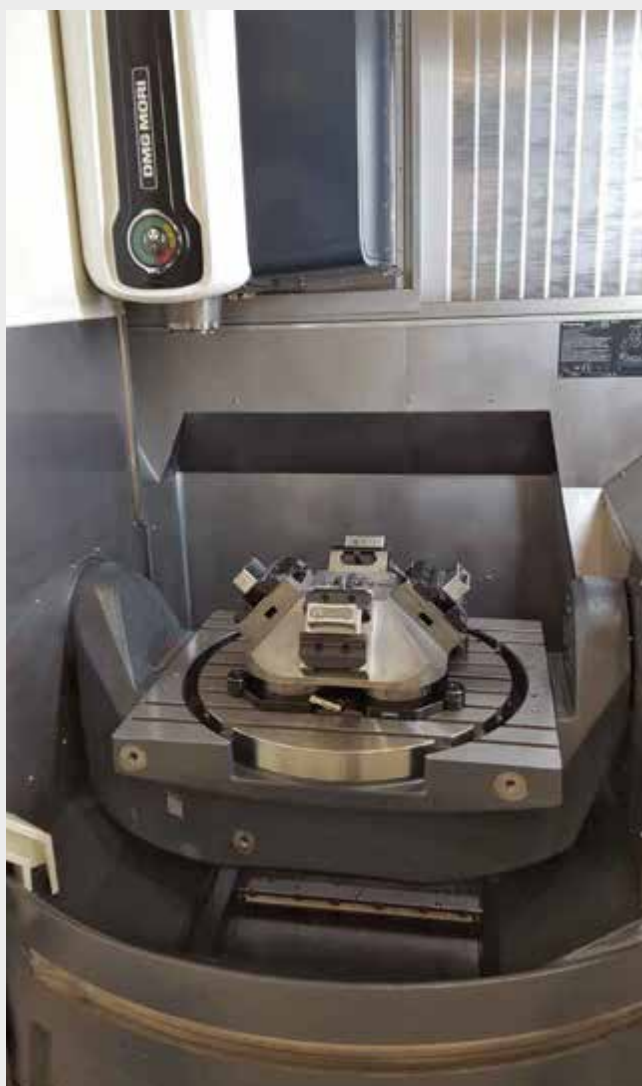
Pyramide 4-fach Mit 4 C2 125 L-160 Pyramid 4-fold With 4 C2 125 L-160
