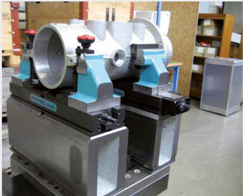
duogrip Palette und Unterbau zur Aufnahme von Alu-Gehäusen, Spannung mit Spezial Prismenbacken duogrip Pallet and base support to mount an aluminium cast shaft, clamping using special prismatic jaws
