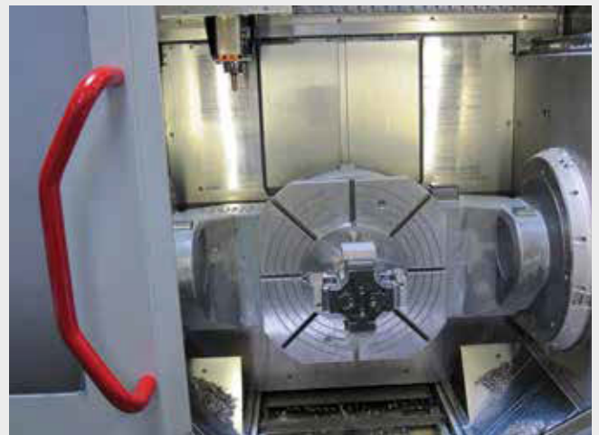
solinos 65-4V-IT 4-fach Monoblocktrum zur Mehrfachspannung auf Hermle Maschine 4-fold monobloc tower for multiple clamping on a Hermle machine
