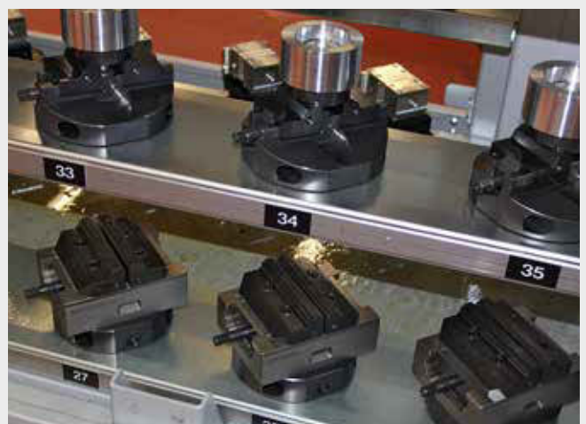
Beladung der Automation nur hinteres Modul VERO-S mit Paletten vom Speicher P60 In automation mode exclusively load the rear VERO-S module with pallets from the P60 storage
