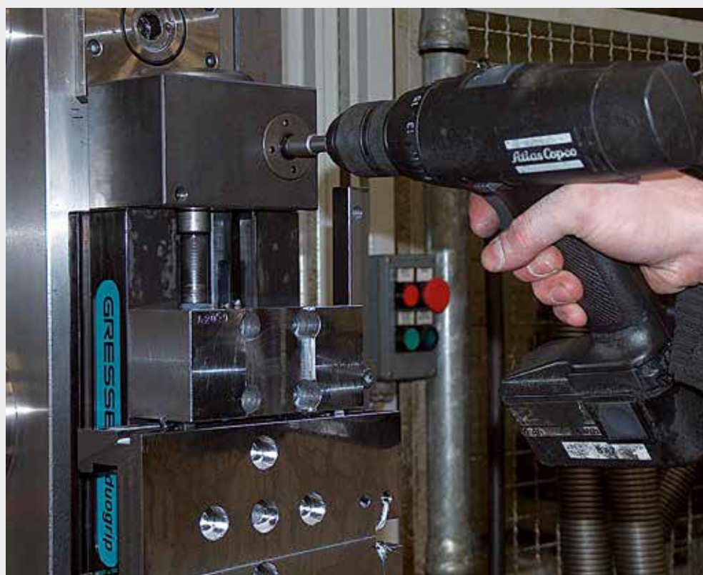
duogrip Winkeltrieb Spannen mit Akkuschrauber (Schneckengetriebe Übersetzungsverhältnis 1:13). 30 kN mit 25 Nm duogrip angle drive Clamping using a cordless screwdriver (worm gear, transmission ratio 1:13). 30 kN at 25 Nm
