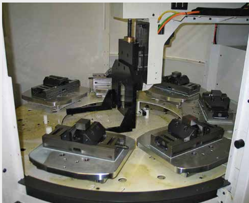
C2 125 L-300 Mit 5-Achs Backe Breite 125 und Stufenbacke grip 5 mm in einer Mikron Automation C2 125 L-300 With 5-axis jaw width 125 and stepped grip jaw 5 mm in a Mikron automation
