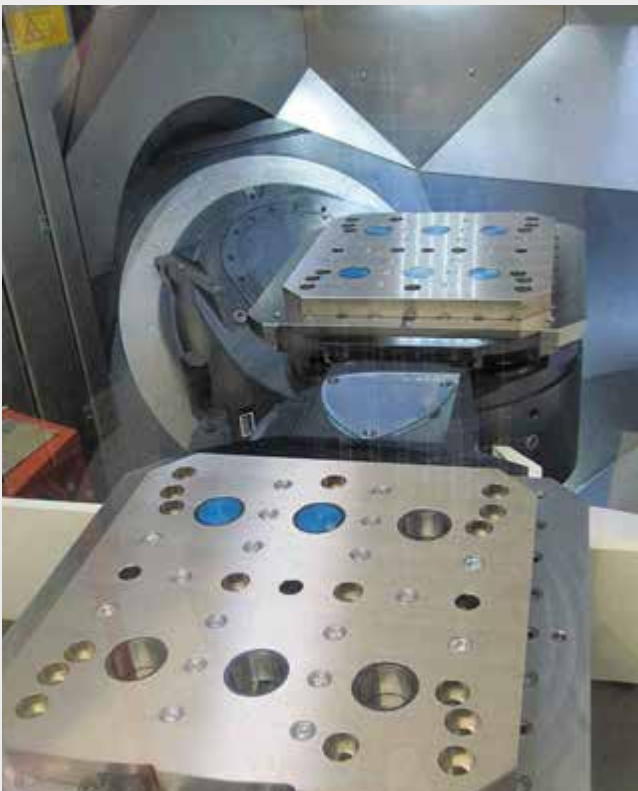
gredoc NRS Platte 6-fach, 400 x 400 mm 2 Platte gredoc NRS auf Grob 5-Achs Maschine gredoc NRS plate 6-fold, 400 x 400 mm 2 gredoc NRS plates on Grob 5-axis machine
