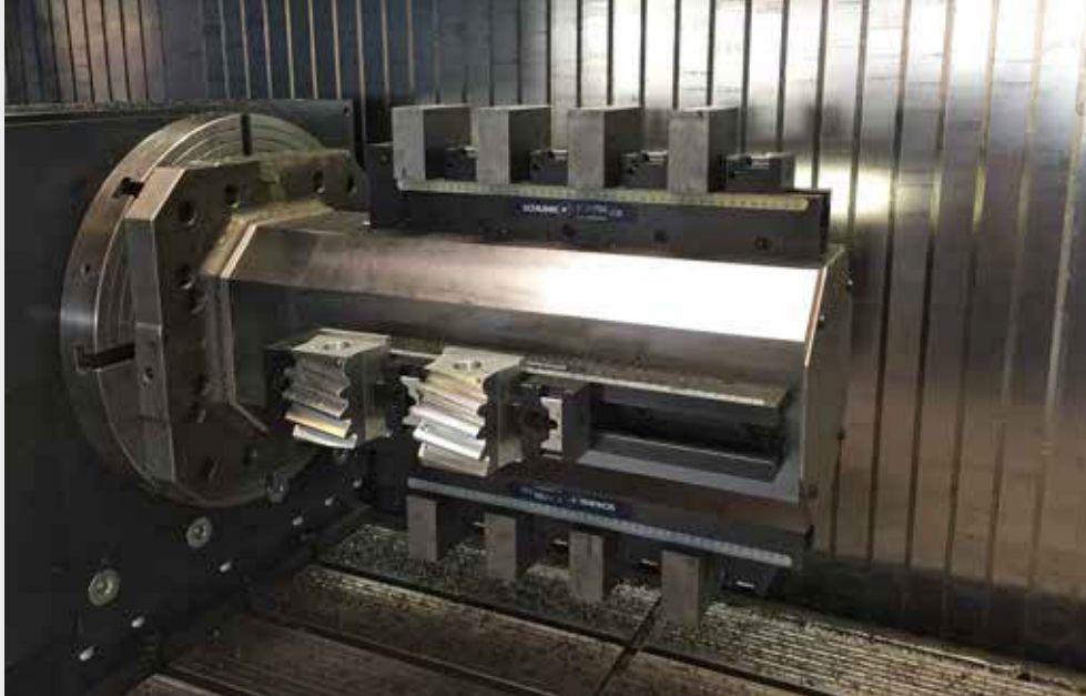
multigrip Mehrfachspanner multigrip Turm auf 4. Achse multigrip multigrip multiple vice tower on fourth axis
