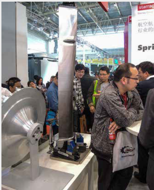
duogrip Spezial Spannlösung zum Spannen von grossen Turbinenschaufeln duogrip 125-AL Clamping solution to clamp big turbine blades
