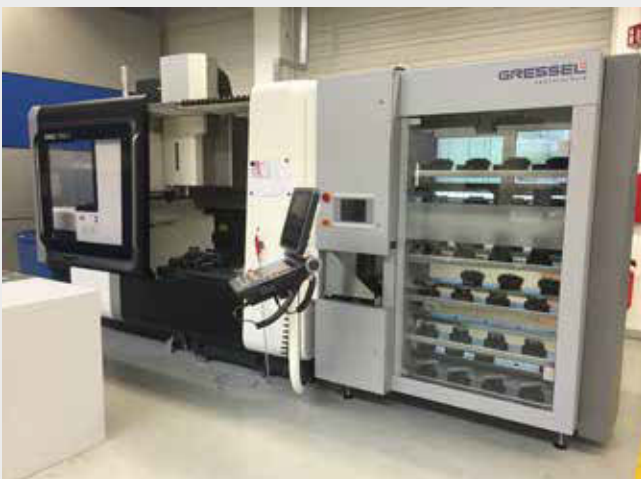
Variante 2 Automatischer Betrieb mit Werkstückspeicher und 56 Spannmitteln
