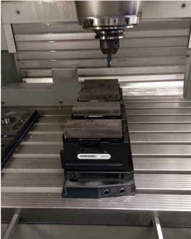
solinos 40 Spannpalette 4-fach mit 4 solinos 40 montiert auf gredoc eckig solinos 40 Clamping pallet 4-fold with 4 solinos 40 mounted on rectangular gredoc
