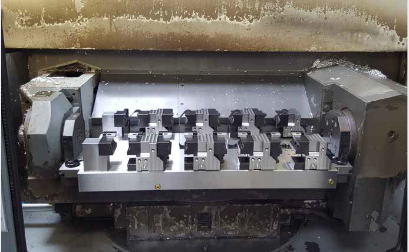
CHIRON Doppelspindler mit 4. Achse, GRESSEL Einzelspannblöcke hydraulisch mit Hub von 30 mm pro Spannstelle CHIRON double spindle with 4th axis, GRESSEL individual hydraulic clamping blocks with a stroke of 30 mm per clamping point
