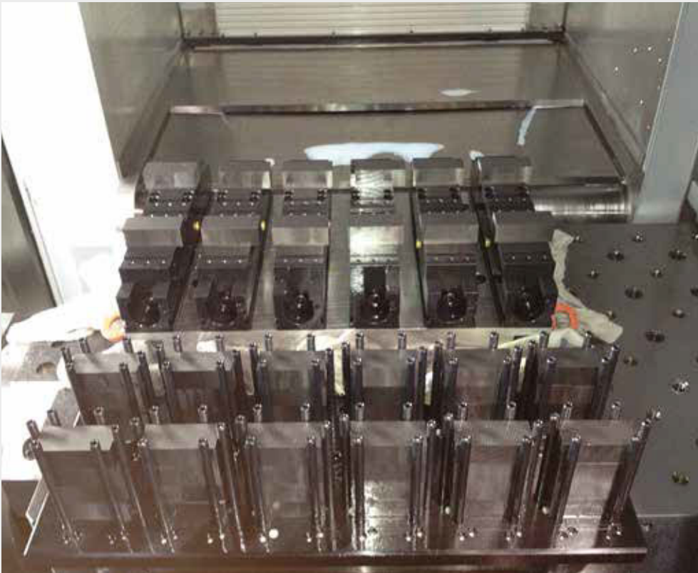
solinos 65-H 12 solinos 65-H auf einer Palette. Werkstückspeicher auf der Maschine und Beladung über Spindelgreifer solinos 65-H 12 solinos 65-H on a pallet. Workpiece storage on the machine and load on spindle gripper
