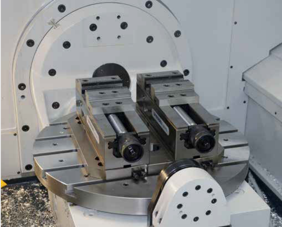
gripos 125-VS 2 gripos 125-VS mit Stufenbacke grip 8 mit T-Nut und gredoc NRS 400 x 400 auf Spinner Maschine gripos 125-VS 2 gripos 125-VS with stepped grip jaw 8 with T-slot and gredoc NRS 400 x 400 at Spinner machine
