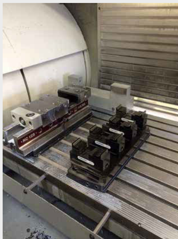
solinos 40 Spannpalette 4-fach mit 4 solinos 40 montiert auf gredoc eckig solinos 40 Clamping pallet 4-fold with 4 solinos 40 mounted on rectangular gredoc
