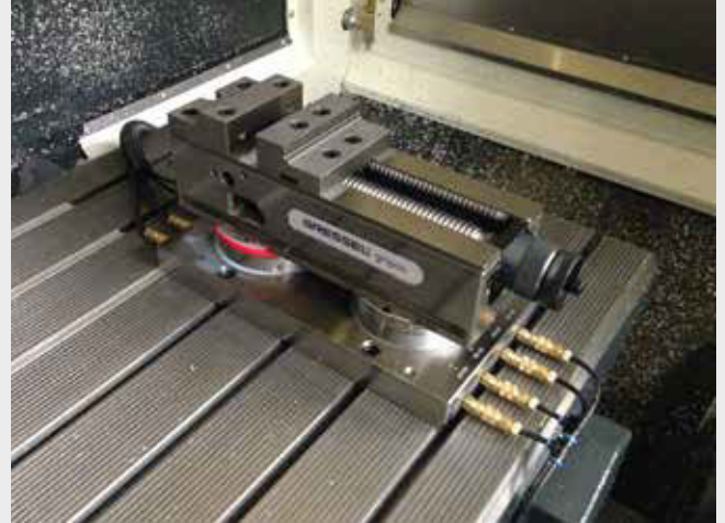
Beladung beide Module VERO-S mit gripos 125-VS Loading both VERO-S modules with gripos 125-VS
