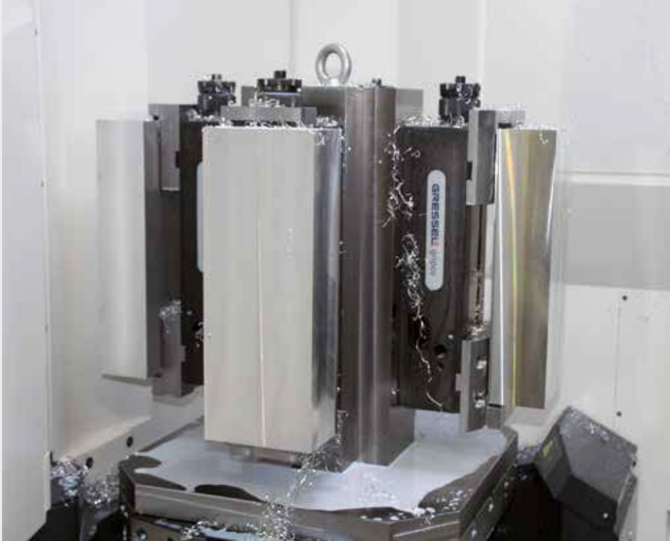
gripos 125-4V gripos 125 (Aufspannturm mit Sonderbacken) auf einer 500 x 500 mm Palette für Horizontal-Bearbeitungszentrum gripos 125-4V gripos 125 (tombstone with special jaws) on a 500 x 500 mm pallet for horizontal machining centre
