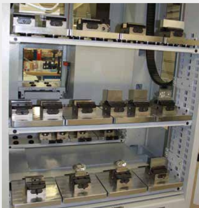
C2 125 L-160 Mit Wendebacken grip auf HERMLE Maschine mit Palettenautomation C2 125 L-160 With reversible grip jaw on a HERMLE machine with pallet automation
