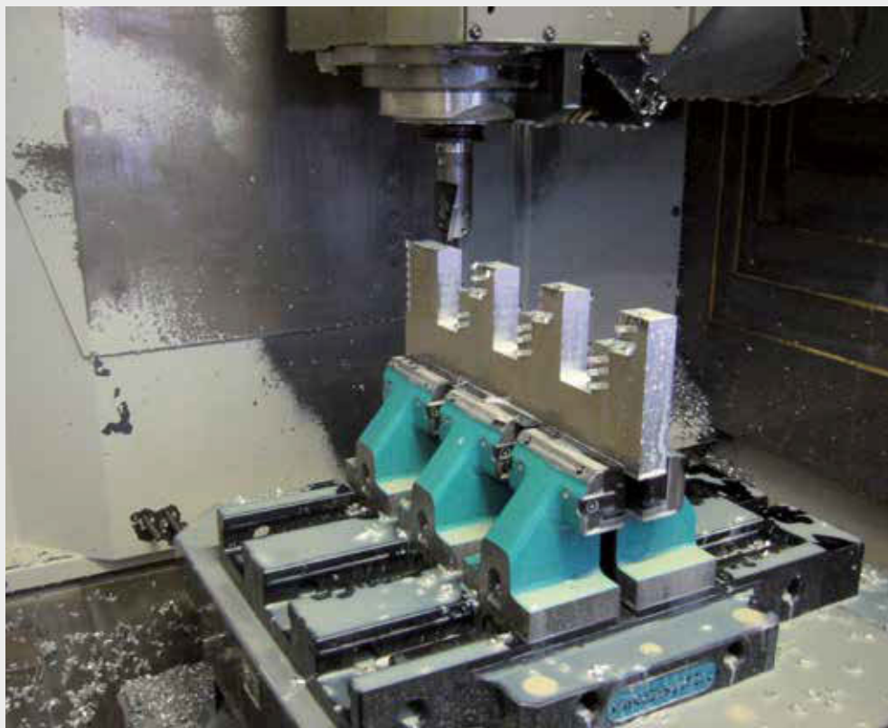
duogrip duogrip mit 5A-Trägerbacken integriert in einer Palette duogrip duogrip with 5-axis support jaws integrated into a pallet
