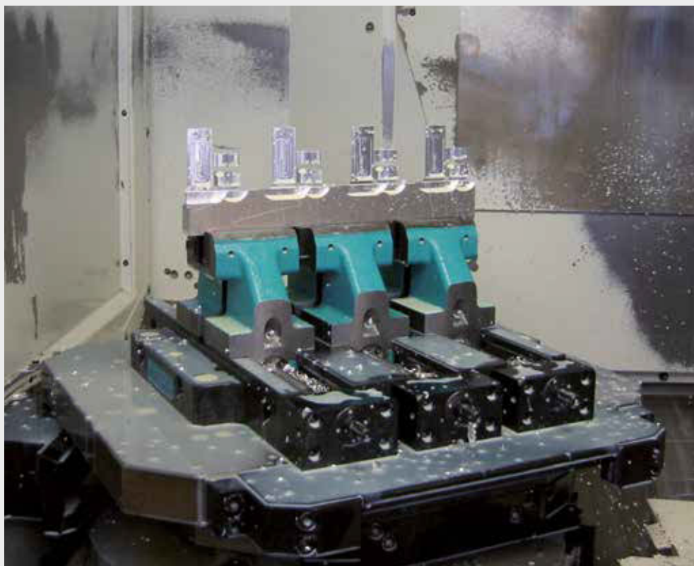
duogrip IP duogrip 100 5A-C integriert in Palette mit geringer Einspanntiefe (Backen grip 3 mm) duogrip IP duogrip 100 5A-C integrated into pallet with close clamping (grip jaw 3 mm)
