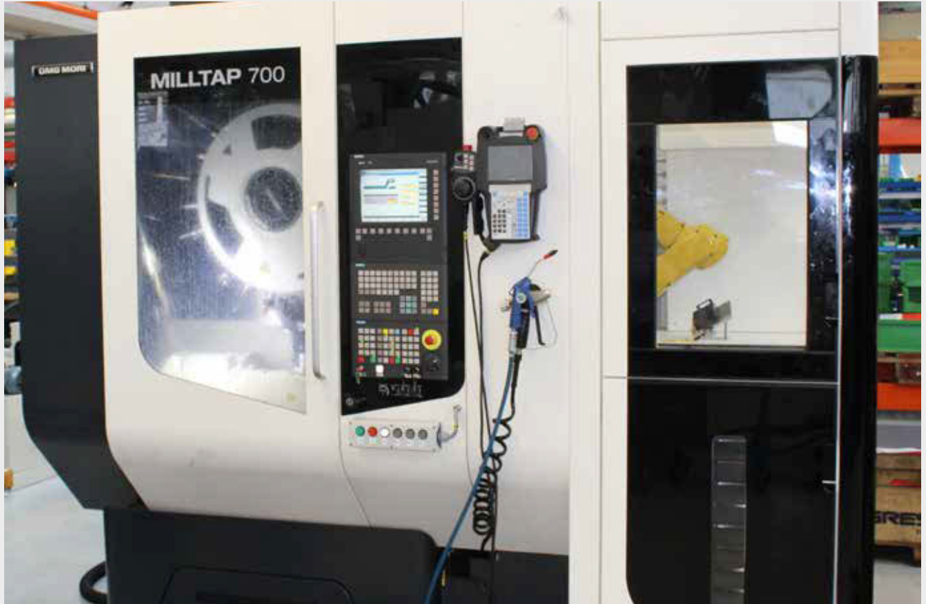
solinos 100 hydraulisch Auf DMGMORI MILLTAP 700 mit FANUC Roboter solinos 100 hydraulic On DMGMORI MILLTAP 700 with FANUC roboter
