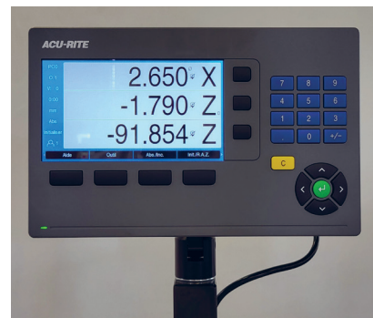
Visualisateur électronique pour 3 axes
